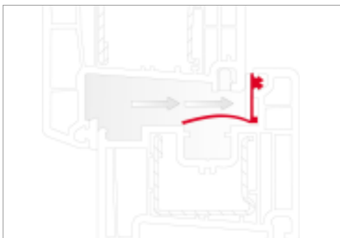
Posición del ventilador con una presión del aire normal
